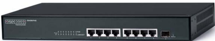
ES4308-PoE は 10/100/1000BAST-T を 7 ポート、ギガビットコンボポート(RJ45/SFP)を 1 ポート搭載している。IEEE802.1af 準拠の給電機能を 8 ポートでサポートしており、例えば 15.4W では 4 ポート、7.5W では 8 ポートへの給電が可能。また、VLAN、リンクアグリゲーション、ポートミラーリングなどに対応。ファンレスであり、稼動時も静音だと言う。
