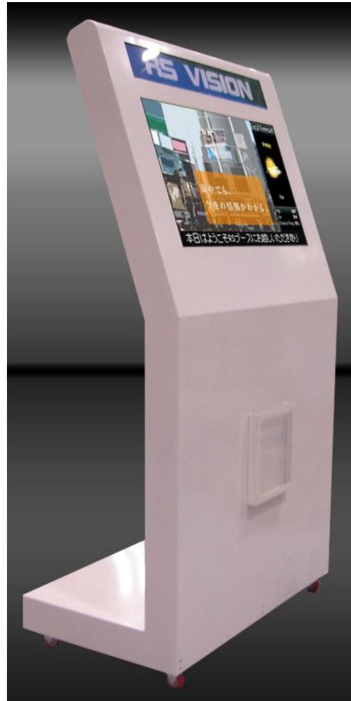
設置や移動も簡単。上部のビルボードバックには、CO2削減を配慮した省エネ・長寿命のCCFLランプ（冷陰極管蛍光灯）を設置しています。付属のソフトウェアで簡単にコンテンツを作成し、USBやネットワーク経由で配信できます。
