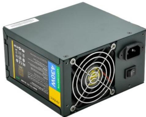
EA-430D-GREEN の最大出力合計は 430W です。2 系統の+12V 出力で、安定したシステムの動作環境を提供します。静音 80mm ファンを搭載しています。最小ノイズで優れた冷却性能を発揮します。直線的なエアフローを構築することにより、効果的に内部の冷却を行います。
