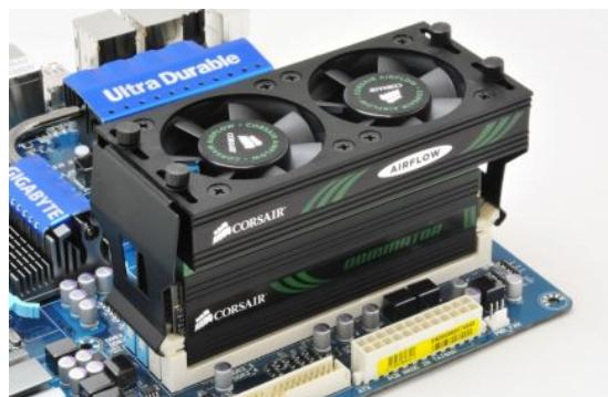
放熱を最大化すると同時に信頼性を向上させる Corsair Memory 独自の冷却技術 DHX(Dual-Path Heat Exchange)を搭載しています。DHX は伝導と対流という 2 つの熱消散経路で従来では難しかったプリント板(PCB)内の冷却※を実現しています。
