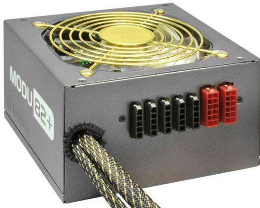
メイン 24 ピン電源コネクタ、8 ピン 12V 電源コネクタ、4 ピン 12V 電源コネクタ、6+2 ピン PCI-E 電源コネクタ、SATA 電源コネクタ、ペリフェラル電源コネクタ、FDD 電源コネクタを利用できます。Core i5/i7 や DirectX 11 に対応した最新のグラフィックスカードも安心して使えます。脱着式ケーブルを採用しています。ケーブルの混線が少なく、ケース内部に最適なエアフローを構築できます。
