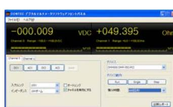
本製品は、高精度 5 1/2 枚、2 チャネル同時計測可能な PCI バス対応のデジタルマルチメータボードです。直流電圧/電流、交流電圧/電流、抵抗の 5 つの測定機能を備えています。
