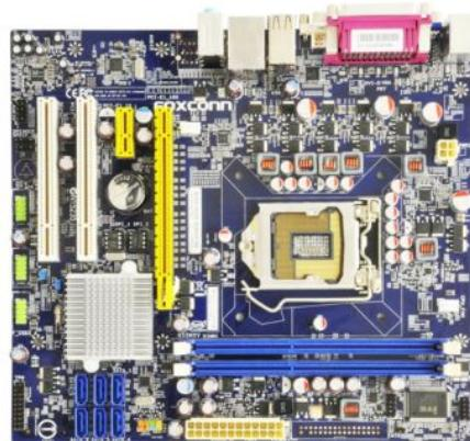
2 本のメモリに同時にアクセスを行い、転送速度を向上させるメモリのデュアルチャネル動作に対応しています。DDR3 メモリをサポートし、動作周波数 1333MHz に対応します。
