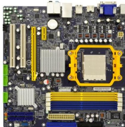
接続バスには、従来の PCI Express1.1 に加え、2 倍の帯域幅を実現する新世代バス規格の PCI Express2.0 をサポートします。PCI Express1.1 と互換性を持ち、データ転送速度が 16 レーンでは 16GB/秒と、より高速なデータ転送が行なえます。
