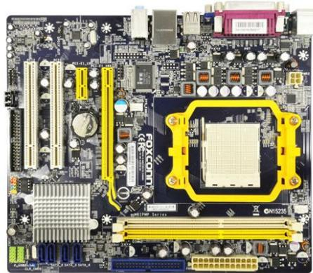
2 つのメモリに同時にアクセスを行い、転送速度を向上させるメモリのデュアルチャンネル動作に対応しています。DDR3 メモリをサポートし、動作周波数 1333MHz に対応します。
