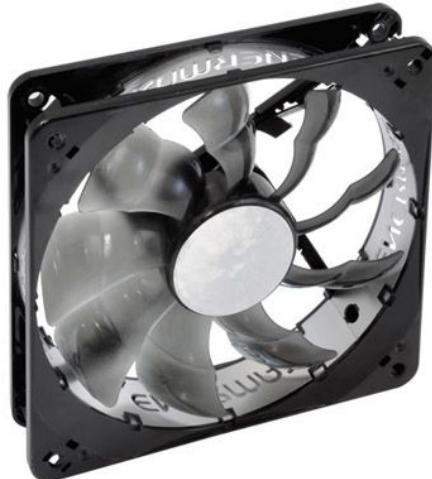
ファンの側面から空気を取り込むハロフレーム構造を採用しました。通常のフレームより多くの空気を取り込むことができ風量が 20~30% 向上しています。
