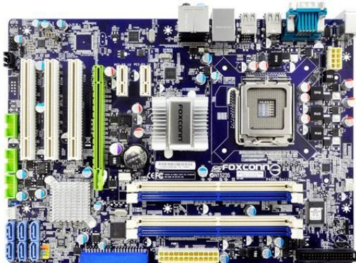
2 本のメモリに同時にアクセスを行い、転送速度を向上させるメモリのデュアルチャンネル動作に対応しています。DDR2 メモリをサポートし、動作周波数 1066(OC)/800/667MHz に対応します。
