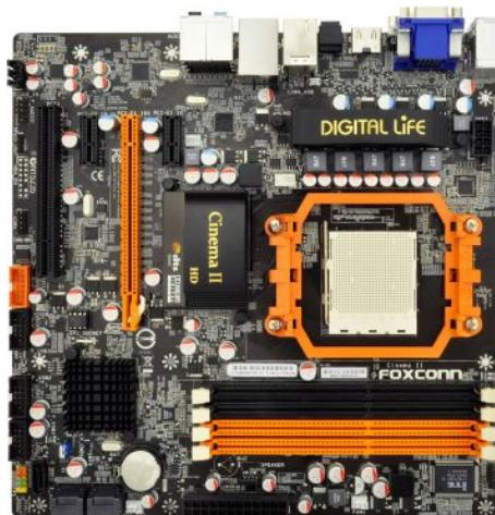
高い耐久性を実現するアルミ固体電解コンデンサを採用しています。電解コンデンサに比べ経年劣化が少なく、さらに高い耐久性を実現します。
