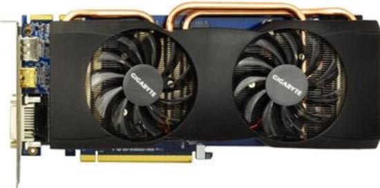
GIGABYTE 独自設計のデュアルファンを搭載しています。冷却性能を高めながら、静音性も実現しています。なだらかに傾斜した独特のデザインは、効果的に熱を分散させます。3つのヒートパイプを搭載し、リファレンス仕様のファンシングよりも約 27%低い温度を実現しています。
