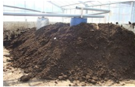
UB高温菌と活性汚泥を混ぜて積み上げイオンエアを循環。
