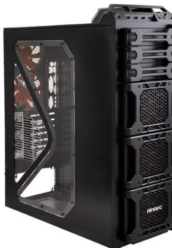
トップにスピード調節機能付 140mm TwoCool ファン×2、フロントにスピード調節機能付 120mm TwoCool ファン×3、リアにスピード調節機能付 120mm TwoCool ファン×2を搭載しています。さらにサイドに 120mm ファン(オプション)×1、増設できます。発生するあらゆる熱を強力に排気します。
