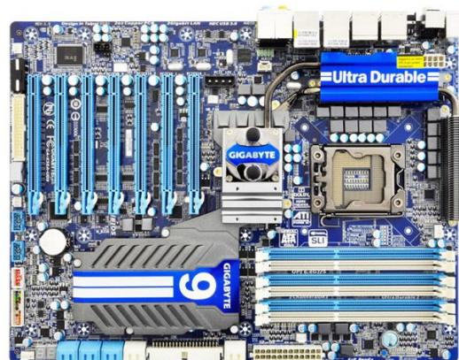
XL-ATX 規格を採用したマザーボードです。通常の ATX 規格より PCB 基盤のサイズを大きくすることで、拡張スペースを最大限に引き出しています。PCI-Express X16 スロットを 7 本搭載することで、4-Way SLI/CrossFireX など大幅な拡張に対応します。
