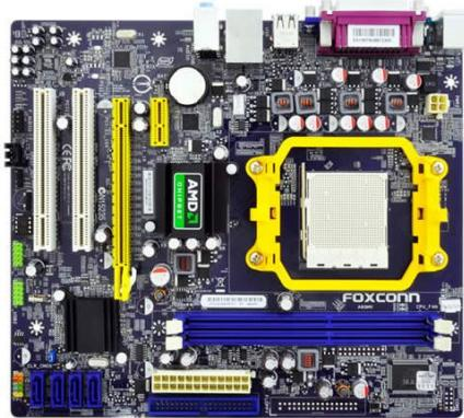
2 本のメモリに同時にアクセスを行い、転送速度を向上させるデュアルチャネル動作に対応しています。DDR3 メモリをサポートし、動作周波数 1333/1066Hz に対応します。
