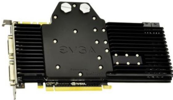
swiftech製の専用水冷ブロックを搭載しています。クロームメッキ処理が施されたベースプレートにはC110銅が採用がされており、ヘッド接触部分には0.6mm×0.6mmピッチの間隔で格子加工がされています。冷却性能を極限に高めることで、様々なシステム構成でも安定した性能を発揮するだけでなく、極限のオーバークロックにも対応します。
