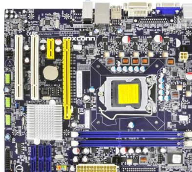
2 本のメモリに同時にアクセスを行い、転送速度を向上させるメモリのデュアルチャンネル動作に対応しています。DDR3 メモリをサポートし、動作周波数 1333/1066/800MHz に対応します。
