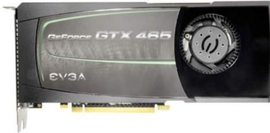
NVIDIA のマルチ GPU テクノロジである SLI に対応します。SLI は、複数のグラフィックカードを並列動作させ、GPU への処理バランスを分散し、3D 処理能力をより高める技術です。
