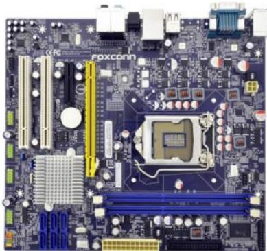
CPU 周りに高い耐久性を実現するアルミ固体電解コンデンサを採用しています。電解コンデンサに比べ経年劣化が少なく、さらに高い耐久性を実現します。
