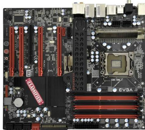
10フェーズデジタル PWM を搭載しています。スイッチング周波数 1333Khz まで対応しているので、極限のオーバークロックにも対応できる設計を採用しています。
