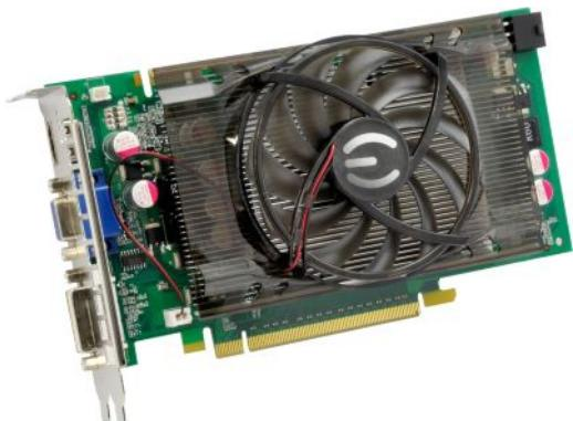
接続バスは、PCI Express1.1に加え、2倍の帯域幅を実現するPCI Express2.0をサポートしています。16レーンでは、より高速なデータ転送(16GB/sec)を行えます。
