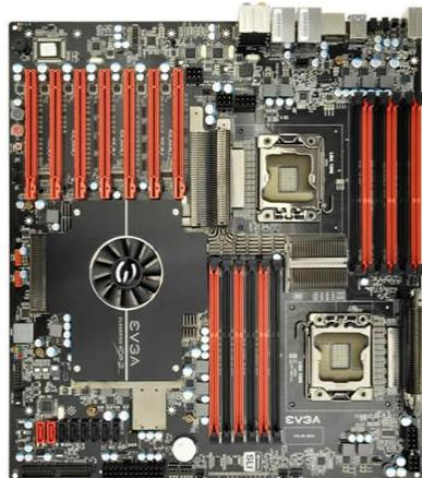
日本メーカー製の固体コンデンサを採用しています。低インピーダンス、低 ESR の固体コンデンサは従来の電解コンデンサに比べ経年劣化が少なく、高い耐久性を実現しています。
