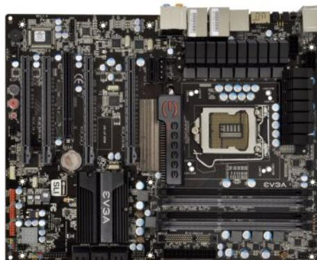
固体コンデンサを採用しています。低インピーダンス、低 ESR の固体コンデンサは従来の電解コンデンサに比べ経年劣化が少なく、高い耐久性を実現しています。
