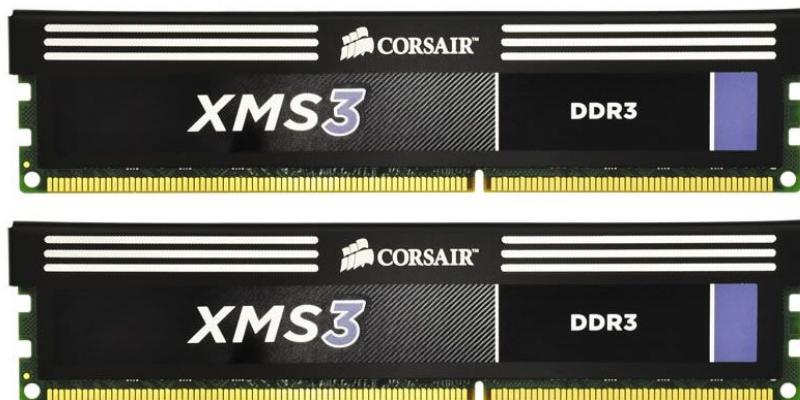
Intel が独自に仕様を策定した規格、XMP(Extreme Memory Profile)に対応しています。SPD を拡張し自動的にメモリーのオーバークロックを行なう機能です。XMP 対応マザーボードにて、簡単に安定したオーバークロックを行うことができます。
