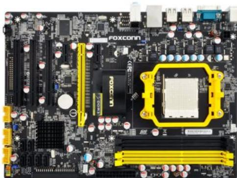
SATA 3Gb/s インターフェースに対応しています。従来の 1.5Gb/s SATA インターフェイスの 2 倍の最大データ転送速度を実現します。高速なデータ転送により快適なドライブ環境を提供します。
