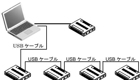
本製品は、パソコンの USB ポートからアナログ信号の出力機能を拡張する USB2.0 対応のアナログ出力ユニットです。高精度 16bit のアナログ出力に加えて、デジタル入出力(LVTTL レベル、各 4 点)とカウンタ(32bit、LVTTL レベル 1ch)を搭載しています。
