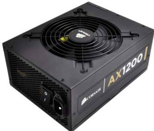
80PLUS GOLD 認証を取得しています。効率性が高いほど、低発熱で耐久性が向上します。電気代の節約と環境にやさしい電源です。GOLD は、電源の負荷率が 20%のとき変換効率が 87%以上、負荷率が 50%のとき変換効率が 90%以上、負荷率が 100%のとき変換効率が 87%以上の効率を持つ電源のみ取得できます。
