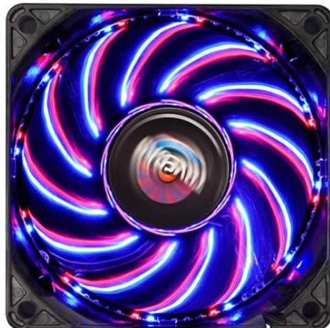
ブレード部分は取り外しができます。埃や汚れの掃除が簡単に行えます。※ファンを取り外す際は、必ず取扱説明書を確認ください。
