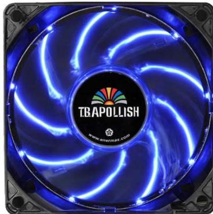
UCTA8N-BLのサイズは82×82×25mm、回転数は1600rpm、静圧は1.482mm-H2O、最小ノイズは20dBA、風量は26.19CFM、ベアリングはツイスターべアリング、MTBF(平均故障間隔)は100,000時間です。
