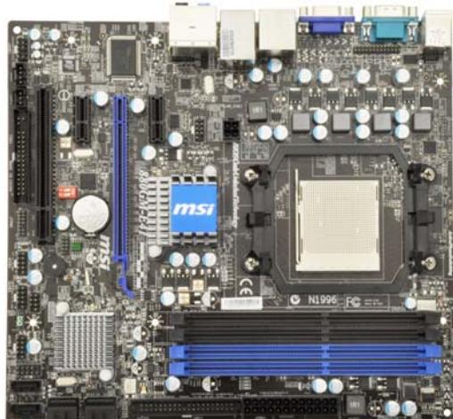
固体チョークコイル「IcyChoke」を採用しています。従来より高出力でOC耐性も強く、高効率で低発熱です。サージやノイズにも強く静かな動作を実現しています。
