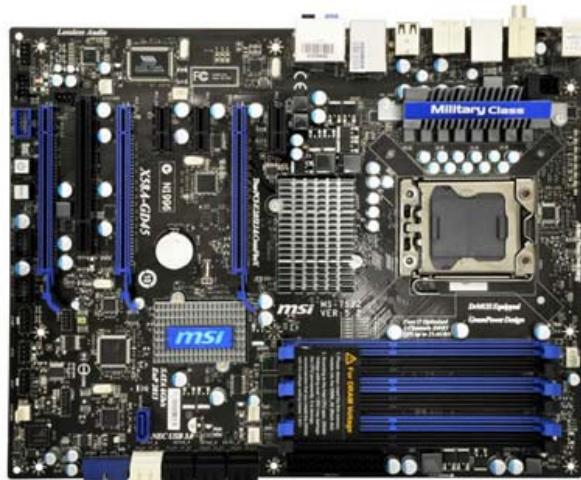
SATA 3Gb/s より約 2 倍の最大転送速度 6Gb/s(理論値)に対応した SATA 6Gb/s インターフェースを搭載しています。SSD など高速なデータ処理に効果を発揮します。
