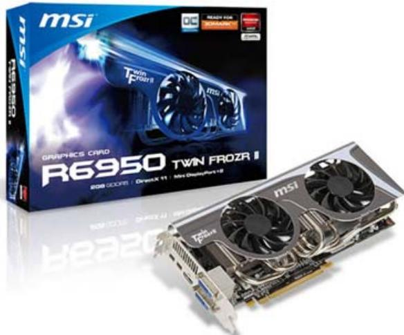
高性能 GPU を支える冷却装置「Twin Frozr II」を採用しています。GPU は高集積化によって処理性能を向上させた反面、そこから発する熱の処理が大きな課題になっています。Twin Frozr (ツイン・フローザー) II は 8mm 径ヒートパイプ 2 本、6mm 径ヒートパイプ 3 本で冷却フィンに効率よく熱を伝え、2 基の 80mm ファンで冷却します。Twin Frozr は過熱から GPU を守り、安定した描画処理を約束します。
