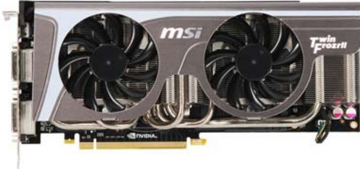
高性能 GPU を支える冷却装置「Twin Frozr II」を採用しています。Twin Frozr (ツイン・フローザー) II はヒートパイプ 5 本で冷却フィンに効率よく熱を伝え、2 基の冷却ファンで強力に冷却します。リファレンスファンと比べ、高い冷却効果を得ることができます。
