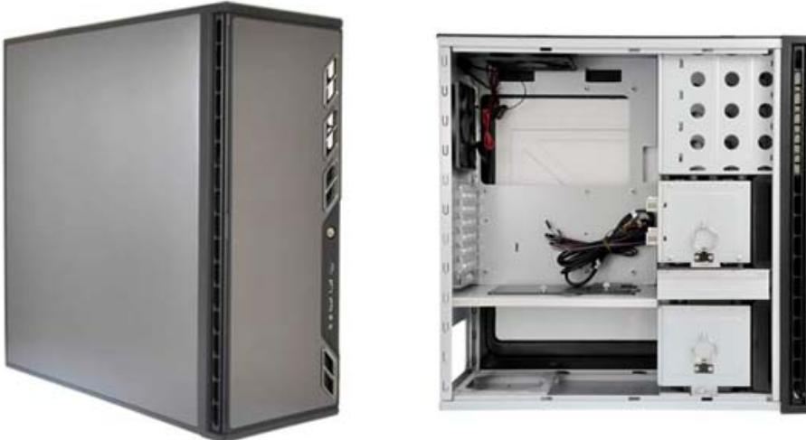
P183-V3 の搭載可能なドライブベイは、5.25 インチベイ × 4、3.5 インチベイ × 1、3.5 インチシャドウベイ × 6 (うち 2 つは 2.5 インチシャドウベイ共用)で構成されます。冷却システムはケーストップとリアに排気用 120mm ファンを各 1 基づつ装備しています。さらに追加オプションにより、120mm ファンを 2 基追加装備できます。冷却性・拡張性の優れたケース設計です。
