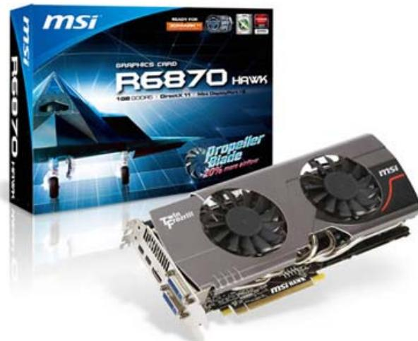
高性能 GPU を支える冷却装置「Twin Frozr III」を採用しています。Twin Frozr (ツイン・フローザー)III は、8mm 径ヒートパイプ 2 本、6mm 径ヒートパイプ 3 本で冷却フィンに効率よく熱を伝えます。ファンは「プロペラブレードファン」を採用することで、送風効率が約 20% 改善しました。過熱から GPU を守り、安定した描画処理を約束します。
