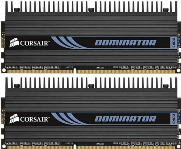
放熱を最大化すると同時に信頼性を向上させる CORSAIR 独自の冷却技術 DHX (Dual-Path Heat Exchange)を搭載しています。DHX は伝導と対流という 2 つの熱消散経路で従来では難しかったプリント板(PCB)内の冷却を実現しています。
