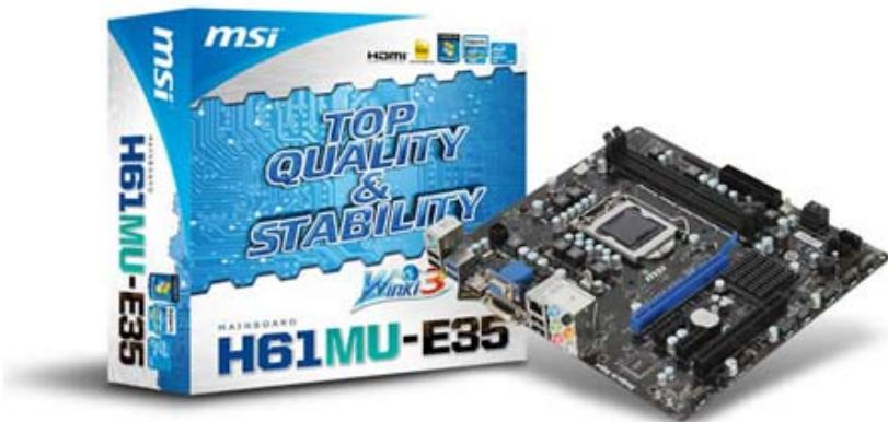
高い耐久性を実現する固体コンデンサを採用しています。従来の電解コンデンサと比べ経年劣化が少なく液漏れや破裂の心配がありません。高効率で低発熱です。OC耐性にも優れています。
