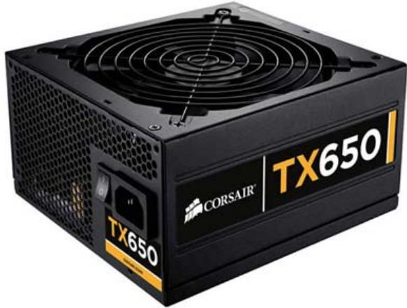
80PLUS BRONZE 認証取得しています。効率性が高いほど、低発熱で静か、そして耐久性が向上します。電気代の節約と環境にやさしい電源です。80PLUS BRONZE は、電源の負荷率が 20% のとき変換効率が 82% 以上、負荷率が 50% のとき変換効率が 85% 以上、負荷率が 100% のとき変換効率が 82% 以上の効率を持つ電源のみ取得できます。
