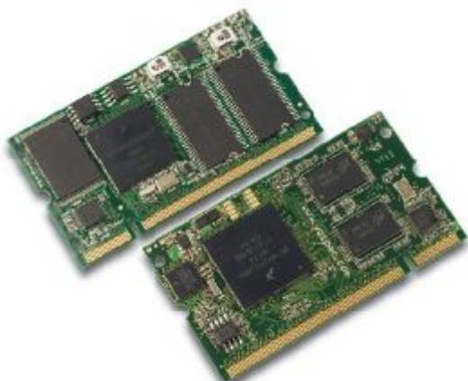
i.MX258 + i.MX515 SODIMMモジュール (同じベースボードの利用が可能)
