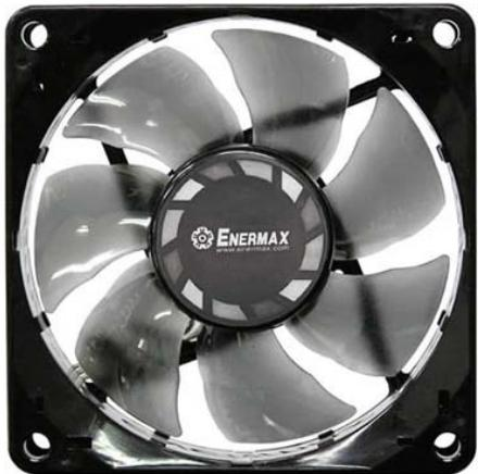
独自のツイスターべアリングを搭載しています。ツイスターべアリングは、摩擦を抑えるためにひとつのパーツで構成されています。マグネティックボールが軸を支えることにより、オイルを注ぐことなく滑らかな動作を実現します。
