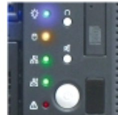
LED表示: 電源・HDD・LAN1・LAN2温度異常
