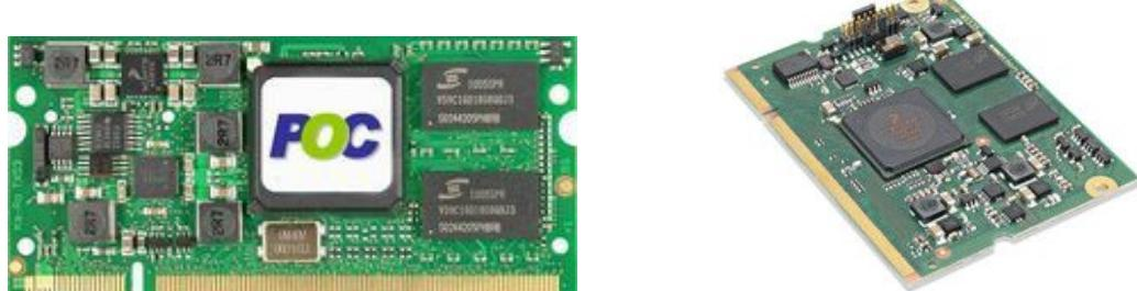
フリースケールセミコンダクタ社製プロセッサ i.MX53 (アイドット・エムエックス 53) 搭載システムオンモジュールおよびベースボードをリリースしました。同時に、i.MX535 (ARM Cortex-A8 1GHz) および i.MX537 (ARM Cortex-A8 800MHz) 搭載システムオンモジュールを利用したクロスプラットフォームをご提案致します。
