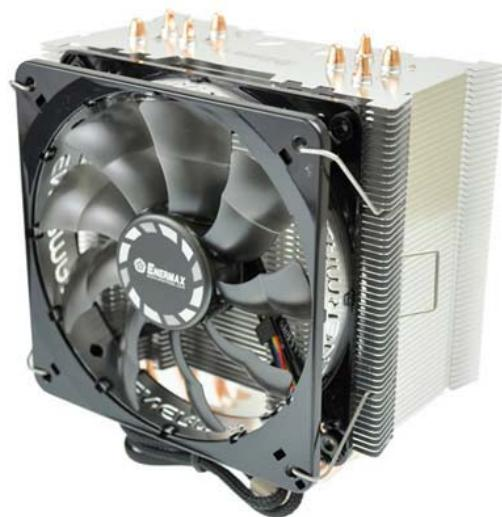
52 枚のアルミニウムフィンすべてに特許を取得した VGF(ヴォルテックスジェネレーターフロー)加工が施されています。ヒートパイプ背面の無風領域に空気を取り込むことで、ヒートシンクの冷却効果を高めます。
