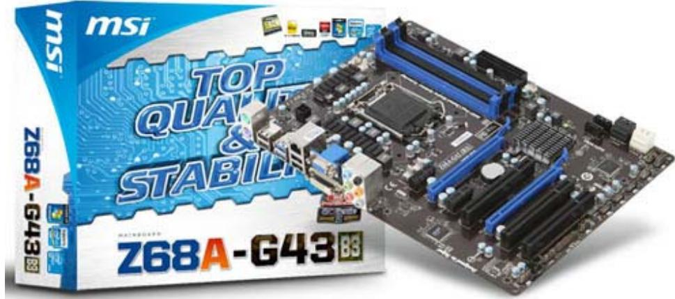
高い耐久性を実現する固体コンデンサを採用しています。従来の電解コンデンサと比べ経年劣化が少なく液漏れや破裂の心配がありません。高効率で低発熱です。OC 耐性にも優れています。
