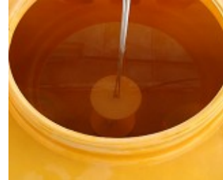
交流電極が水に浸かる水量でご使用下さい。
