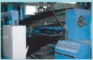
「染色」「分選」された後の綿糸が機会の中に引き込まれていく。ちなみに「染色」「糊付け」される綿糸は、デニムのタテ糸になる。デニムのヨコ糸は通常、白いままの綿糸が使用されるが、今回のモデルでは5色に染められたヨコ糸を採用。
