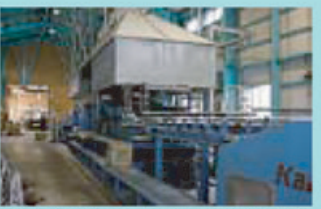
染色されたロープ状の綿糸は「分選」と呼ばれる工程で、再び1本の糸に分けられ、きれいにローラーに巻かれ、「糊付け」の工程に移る。写真は糊付けの機械である。
