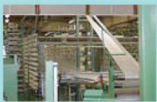
何本もの綿糸がきれいに寄せ集められ、次第に1本の太いロープ状になっていく。誰もが聞いたことがあろロープ染色」とは、この状態でインディゴの層を通して染色するから「ロープ染色」と呼ばれる。
