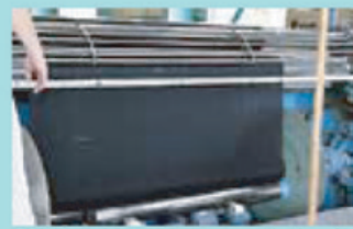
最終、職人の手によってさらにきれいに糸を整えてローラーに巻き付けていく。これが機屋に送られ、織機に装着され、織り上げられていく。
