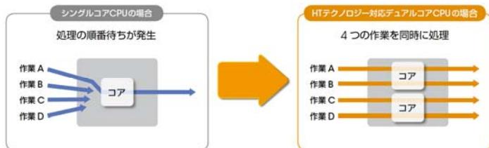
ハイパースレッディング・テクノロジー対応のデュアルコアCPU、Intel® Core™ i7プロセッサ 6200UE 1.06GHzを採用。4つのスレッド(CPU利用の単位)の同時処理が可能となり複数プロセスの同時実行性が大幅に向上了しました。
