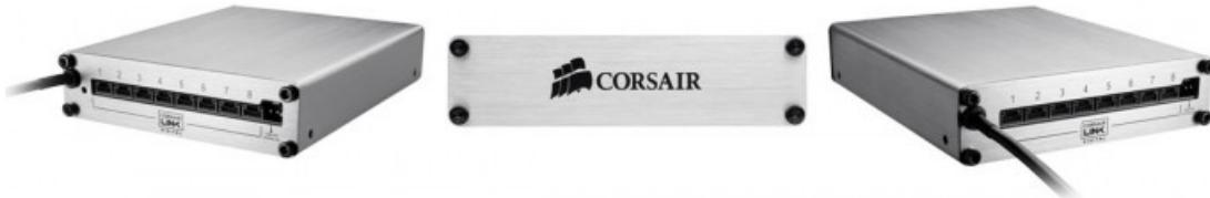
「Corsair Link」は、各 CORSAIR 製品と接続可能なシステム統合管理ツールです。対応の CORSAIR 製品と接続することで温度モニタリングやファン回転数の調整が可能、システム全体を総合的に管理できる専用デバイスです。
